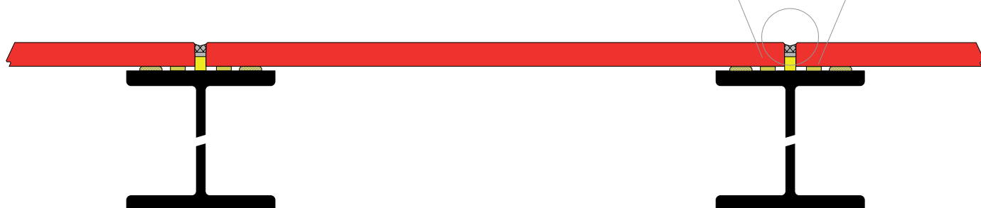
BALKONOVÁ PODLAHOVÁ DESKA UPEVNĚNÁ NA OCELOVÉM NOSNÍKU (NEPŘÍZNANÉ UPEVNĚNÍ – LEPENÍ)
